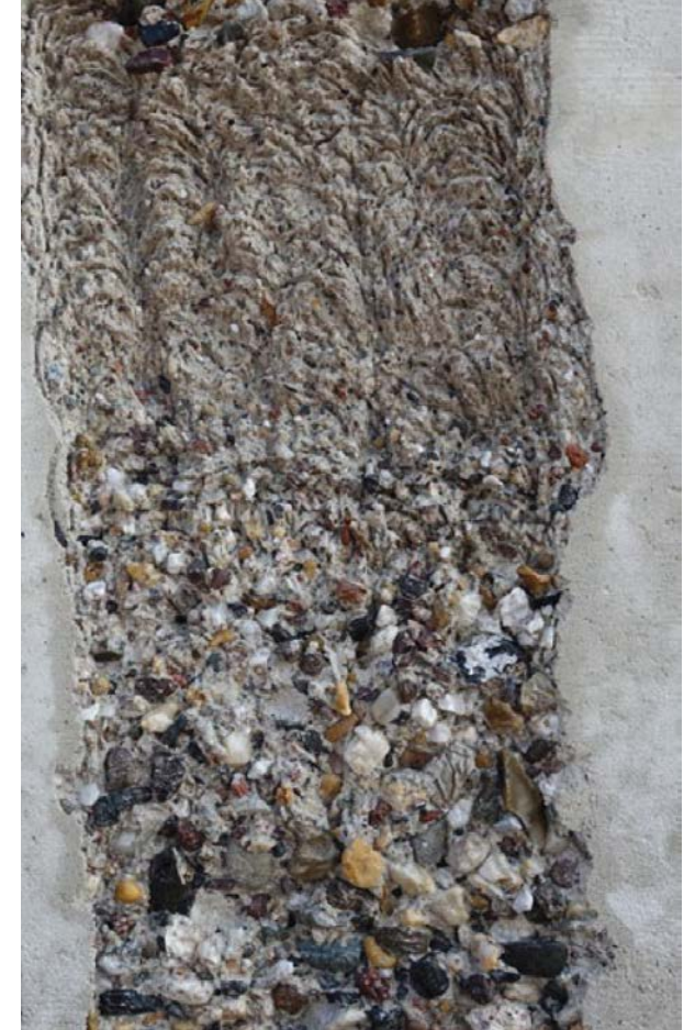
Lähde: Westendarp (2015), Probleme mit der Mischungsstabilität von Beton . Karlsruhe: Bundesanstalt für Wasserbau
