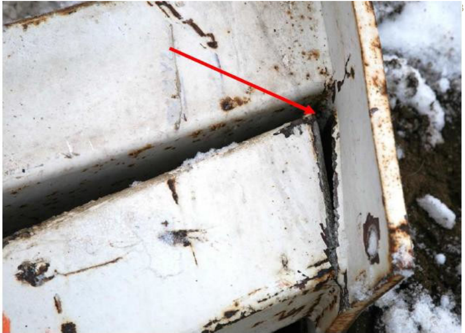
Kuva 11. Harjaliitoskappale, jonka ympärihitsaus oli mahdotonta tilanpuutteen takia. (kuva: poliisi)
